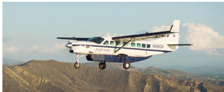
Die Eco Caravan von Ampaire kombiniert den RED-Flugdieselmotor mit einem elektrischen Antrieb und zeigt das Potenzial hybrider Flugkonzepte für größere Reichweiten und geringeren Kraftstoffverbrauch
